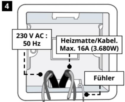
Installieren Sie eine 50 mm tiefe Unterputzdose/Hohlwanddose am bevorzugten Thermostatstandort. Ziehen Sie die Kabel (Heizmatte/Kabel, Netzteil und Sensor(en)) durch die Dose und vervollständigen Sie die Anschlussverkabelung.
