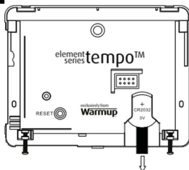
Suchen Sie Ihre CR2032 3-Volt-Lithiumbatterie auf der Rückseite des vorderen Gehäuses. Entfernen Sie den Plastikstreifen unter der Batterie. Die Batterie sollte immer mit der positiven Seite "+" nach außen eingesetzt werden.
