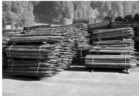
Um ein unkontrolliertes Auswaschen im Erdreich zu verhindern, wird das frisch imprägnierte Holz auf dem Werksgelände gelagert, bis die Fixierung abgeschlossen ist.
