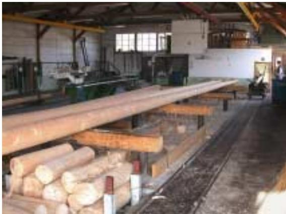
Vor der Druckimprägnierung muss man das Holz entrinden. Je nach Werk wird geschält oder gefräst.
