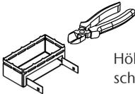
Höhe mittels Seitenschneider anpassen
