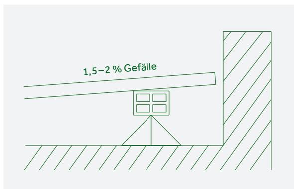
Terrassen sollten immer in einem Gefälle von 1,5–2 % verbaut werden. Bei der Wabenprofilziele muss das Gefälle zwingend in Dielenrichtung laufen – die Massivziele kann auch quer zum Gefälle verlegt werden. Wabenprofile dürfen nicht auf das Niveau angrenzender Rasen- oder Steinflächen verbaut werden. Unsere Ziele *Die Smarte* kann ohne Gefälle verlegt werden.
