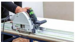
Die GIFAfloor PRESTO Gipsfaserelemente können mit herkömmlichen Holzbearbeitungswerkzeugen gesägt werden. Die Verwendung von diamantbestückten Sägeblättern wird ausdrücklich empfohlen.
