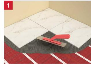
• Bedecken Sie das Heizsystem mit Hilfe einer gezahnten Kelle mit einem kompletten Bett aus flexiblem Fliesenkleber. Achten Sie darauf, den Heizleiter nicht zu beschädigen. Falls die Fliesen kleiner als 90 mm sind, bedecken Sie das Heizsystem erst mit Ausgleichsmasse.
