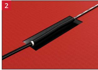
2 Schneiden Sie eine Vertiefung in den Unterboden, damit die Anschlussleitung sich auf einer Höhe mit dem Heizleiter befindet.
