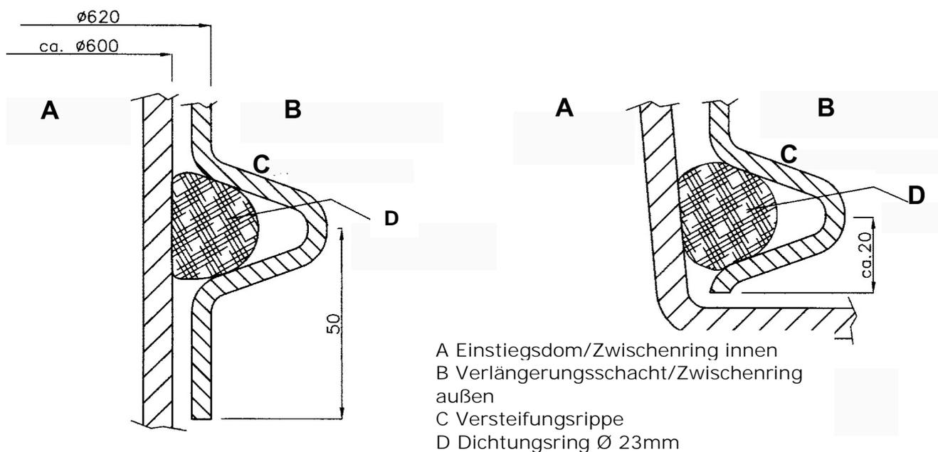
Hinweis: Bei Produkten mit kurzem Einstiegsdom, wie dem Monolith, ET / Tubus oder F-Line Tank, muss der Verlängerungsschacht um ca. 30mm gekürzt werden.
