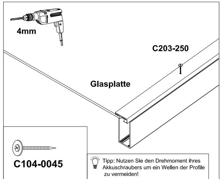
Die Glasplatten und Aluminiumprofile mit den Schrauben (C104-0045) auf den mit 4mm vorgebohrten Sparren montieren. Die erste Schraube wird gemeinsam mit dem Abschlußwinkel verschraubt.
