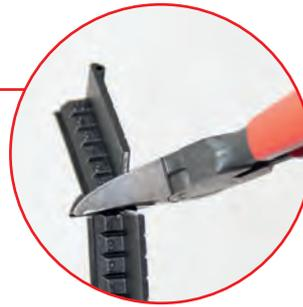
bei Bedarf mit Seitenschneider kürzen
