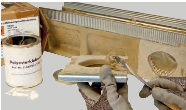
Für das Verkleben sollte die Polyesterklebemasse mit dem richtigen Mischungsverhältnis des Härters vermischt, auf die Klebeflächen aufgebracht und schlussendlich beide Teile miteinander verklebt werden (siehe beiliegende Anleitung)
