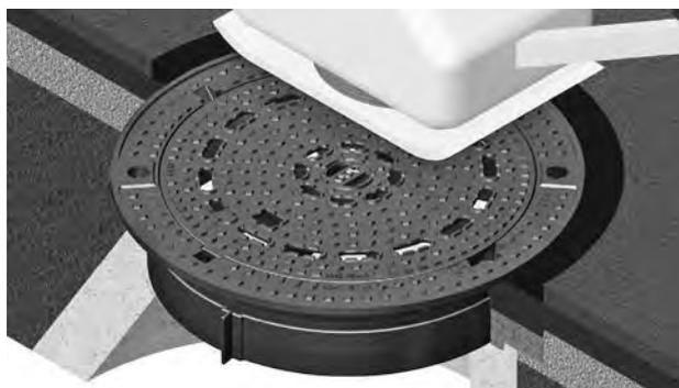
**Bei Einbau von Ausführungen mit BEGU-Deckel empfehlen wir zur Vermeidung von Schäden an der Betonfüllung des Deckels beim Einrütteln der Abdeckung einen alten BEGU- oder Vollgussdeckel in den Rahmen einzulegen.**
