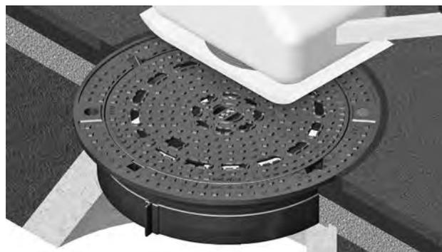
4.6. Den verlaufenden Ringspalt um der Abdeckung mit Fugenvergussmaterial füllen.
