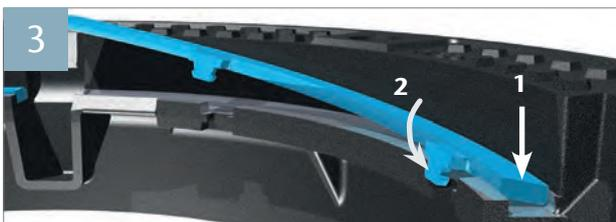
Dämpfende Einlage mit ihrer Außenseite (Seite ohne Befestigungslaschen) in die Nut setzen (1.), anschließend nach vorne in die Nut kippen und die Befestigungslaschen in die dafür vorgesehenen Aufnahmen drücken (2.).
