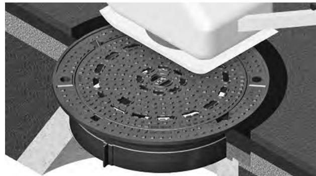
**Bei Einbau von Ausführungen mit BEGU-Deckel empfehlen wir zur Vermeidung von Schäden an der Betonfüllung des Deckels beim Einrütteln der Abdeckung einen alten BEGU- oder Vollgussdeckel in den Rahmen einzulegen.**
