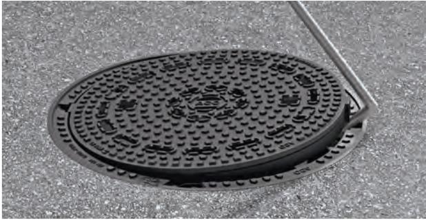
**Öffnen:** Bedienungsschlüssel an den Entriegelungsöffnungen am Rahmen einsetzen und mit einer Handbewegung nach außen den Deckel entriegeln. Anschließend den Deckel mit dem Bedienschlüssel an den Aushebeöffnungen herausziehen. Beim Begehen des Schachtes einschlägige Unfallverhütungsvorschriften beachten.
