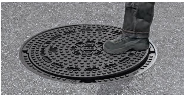
**Schließen:** Auflageflächen an Deckel und Rahmen reinigen. Deckel, Rahmen, dämpfende Einlage und Verriegelungsnocken auf Beschädigungen überprüfen. Deckel unter Beachtung der Einlegesicherung einlegen. Anschließend Deckel mit einem senkrechten Tritt oder Stoß auf den über den Rahmen hinausragenden Teil des Deckels verriegeln. Die Verriegelung ist eingerastet, wenn Deckel und Rahmenoberseite umlaufend auf gleicher Höhe liegen.
