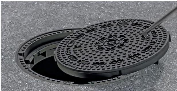
**Wartung:** Die Wartung der Schachtabdeckungen kann im Rahmen der üblicherweise erforderlichen Inspektions- und Wartungsarbeiten der Schächte erfolgen. Dabei Auflageflächen an Deckel und Rahmen reinigen und Deckel, Rahmen, dämpfende Einlage und Verriegelungsnocken auf Beschädigungen überprüfen. Schadhafte Teile ersetzen.
