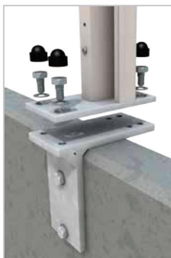
Mit dem Montageadapter können Sie eine SYSTEM Sichtschutzanlage auf einen Beton L-Winkel oder ähnliche Einfassungen setzen. Der Adapter passt zum aufschraubbaren SYSTEM Pfostenträger. Mitgeliefert werden die Schrauben, Unterlegscheiben und Abdeckkappen für die Verbindung dieser beiden Elemente.
