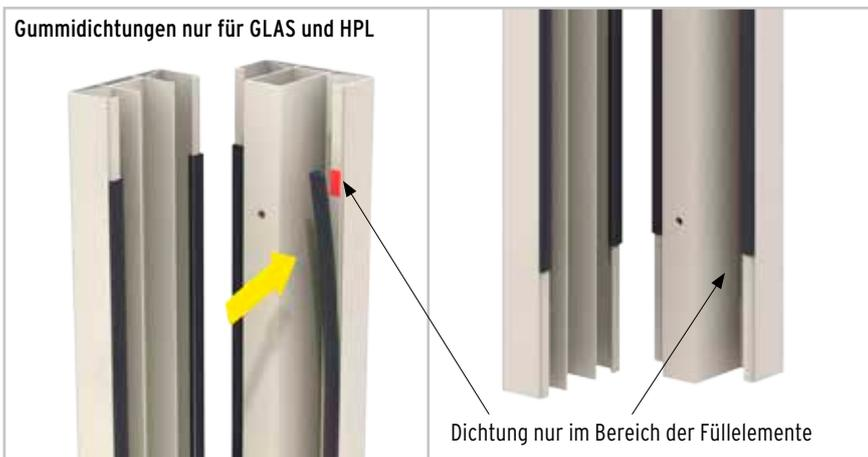
Für Glas und HPL die beiliegenden Gummidichtungen aufstecken und punktuell an 3 Stellen mit doppelseitigem Kleband fixieren.
