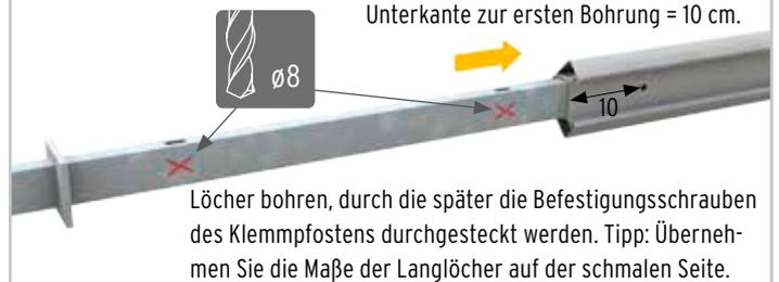
Löcher bohren, durch die später die Befestigungsschrauben des Klemmpfostens durchgesteckt werden. Tipp: Übernehmen Sie die Maße der Langlöcher auf der schmalen Seite.
