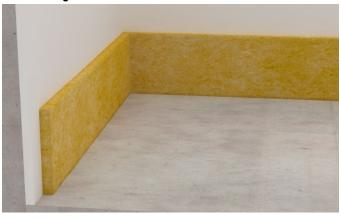
Fertighöhe des Estrichs an allen aufgehenden Bauteilen markieren und GIFAfloor Randdämmstreifen MW mit Oberkante mindestens 5 mm höher als Fertighöhe fixieren.
