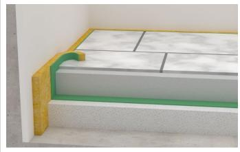
Erst wenn der Oberbelag verlegt ist, den überstehenden Teil des GIFAfloor Randdämmstreifen MW abschneiden (gemäß DIN 18560-2).
