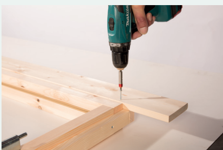
7. Anschrauben der Blende oben
