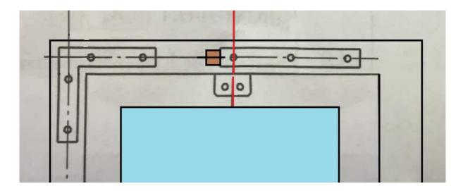
Die Bohrung des Scherenlagers auf der Seite mit der Feder fluchtet mit der Mitte des Flügels
