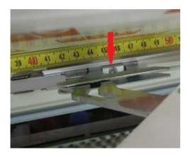
Koppelstange im Klotz der Schere mit Innensechskantschraube (SW3) sichern.
