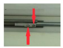
Koppelstange in Klotz der Umlenkung schieben und mit zwei Innensechskantschrauben (SW3) sichern.
