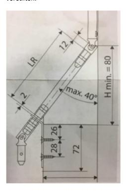
Winkel wie auf der Skizze an der Wand andübeln (2Stk Schnellbauschrauben 5x50 in Dübel 8mm).
